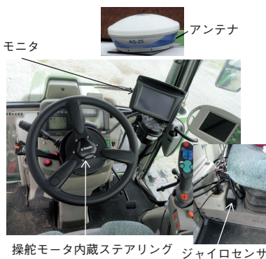
写真1 / 自動操舵システムの構成
