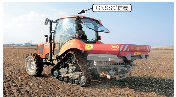
写真2/可変施肥対応ブロードキャスト GNSS受信機を備え、設定した施肥マップに従って適切な施肥量の肥料を散布できます。
