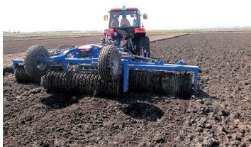
図1 / 乾田直播栽培におけるケンブリッジローラによる鎮圧作業と水みちの減少
