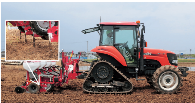
写真1 / スリット成形播種機。白枠線内はスリットを成形するブレードを示す
