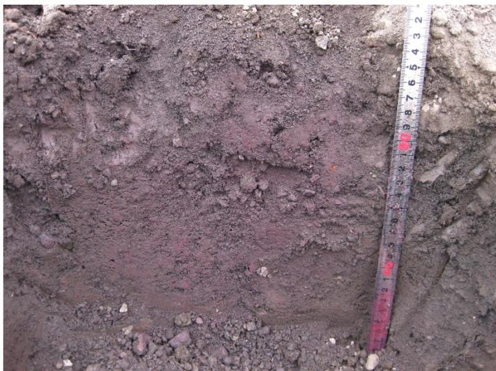
図4 ジピリジル溶液噴霧後の土壌断面(還元処理終了後)
