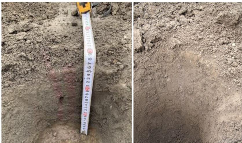
図4 ジピリジル溶液噴霧後の土壌断面（還元処理終了後）
