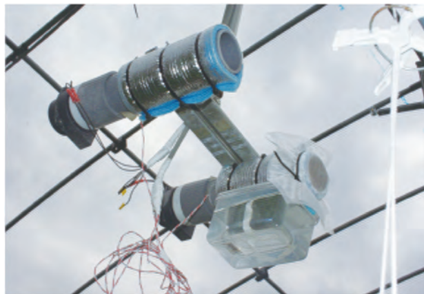
図2 制御用乾湿球温度センサの外観
