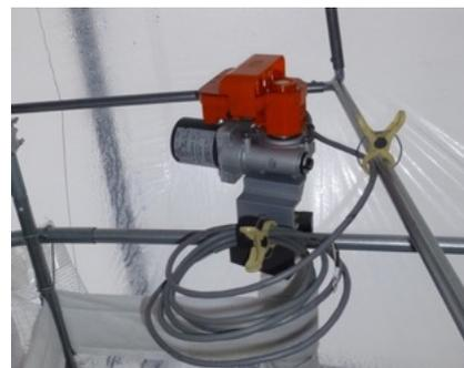
巻き上げ機による多層断熱被覆資材の自動開閉
