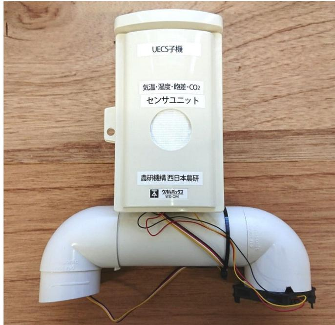
(a)UECS対応センサユニットA型は温室内の様々な気象環境を測定し、施設園芸用装置の共通規格である「UECS」形式で有線LANに送出することができます。
