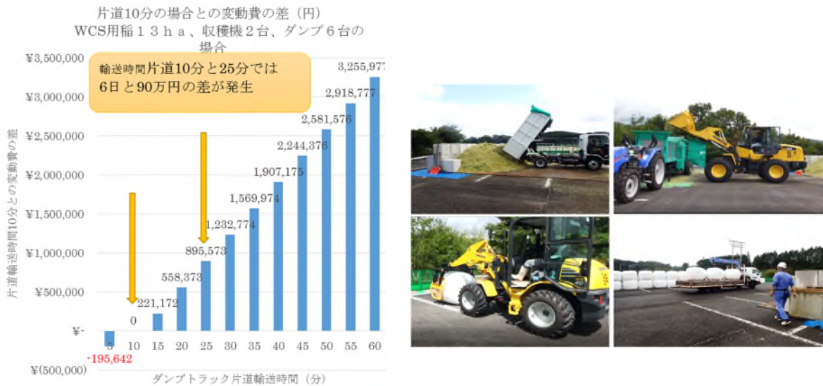
図1-6 スtockヤード設置のコスト試算（左）と実際の設置状況（右）
