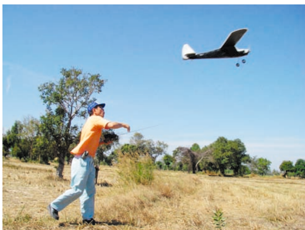
写真1 手投げで離陸するラジコン飛行機 滑走路がなくても空撮が可能
