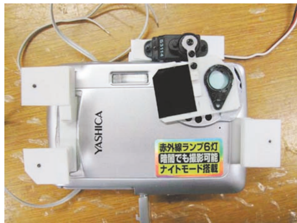
写真2 ラジコンサーボで可視、近赤外フィルタの切り替えを行う
