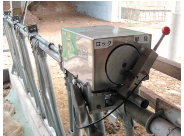
写真2 連動スタンションロック解除機
