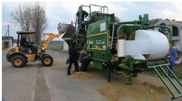
微細断飼料をロールベール成形しラッピングする機械
