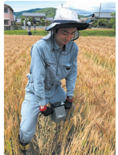
写真2 貫入土壌硬度計を用いた土の硬さの調査
