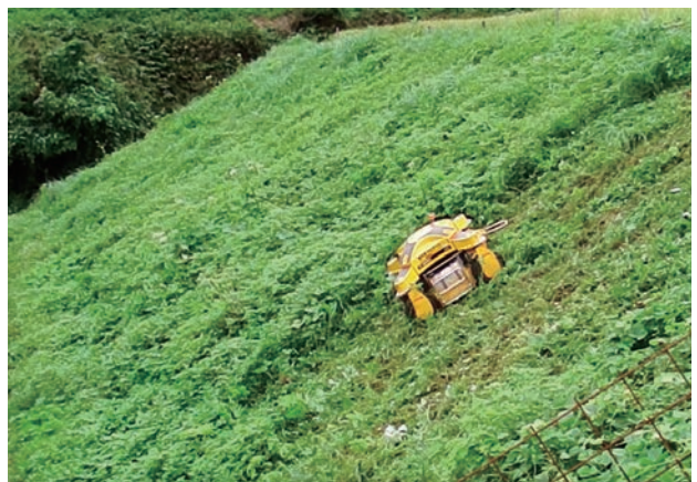
▲写真2 中山間地域に多い長大法面で作業するリモコン式草刈り機(兵庫県養父市能座地区)
