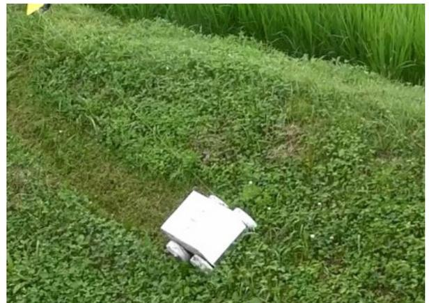
▲写真 急傾斜法面对応誘導式小型草刈機
