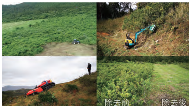
▲写真 各種フレールモアを用いた木や有刺植物の除去
