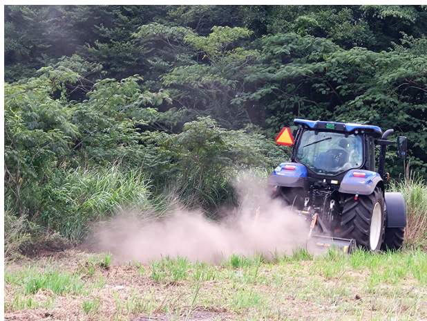
▲写真 トラクタ装着型フレールモアを活用した荒廃農用地の整備（三瓶小屋原地区）
