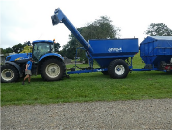
Photo 3.6.4 一時貯留・運搬用のホッパー
