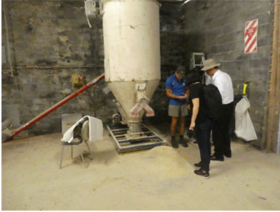
Photo 3.6.3 穀物粉碎機：畜産経営の要望に応じて、メイズや大麦、小麦等を粉碎し、要望に応じた割合で配合して、配達することもある
