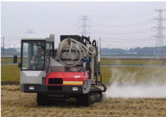
図3 蒸気除草処理の様子
