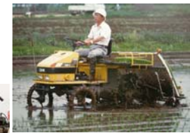
(上) 1980年代に開発された高速田植機 (回転式植付け機構により、従来の約3倍の速さで植付けを実現。)
