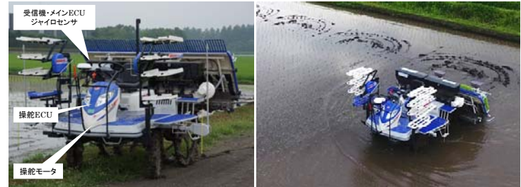
無人作業中の自動運転田植機 (ほ場端で自動旋回している様子)
