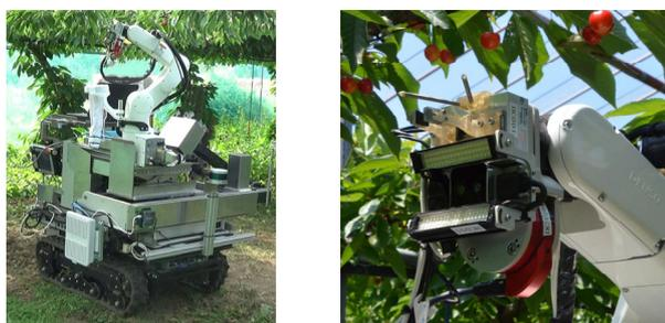
**図3：オウトウ自動収穫ロボット**
