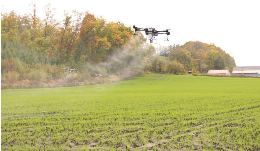
※ 自動飛行農薬散布ドローンによる3台編隊散布
