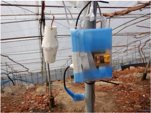
通い農業支援システム (左: 温湿度センサー 右: ラズパイとカメラ)
