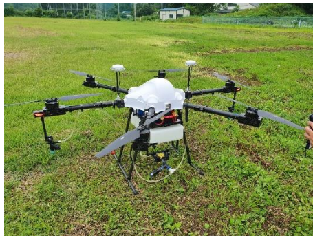
(a) 精密粒剤散布制御システムを搭載したドローン (b) 散布システム制御フロー 局所散布位置
