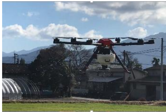
【ドローンによる粒剤（肥料）散布作業】
