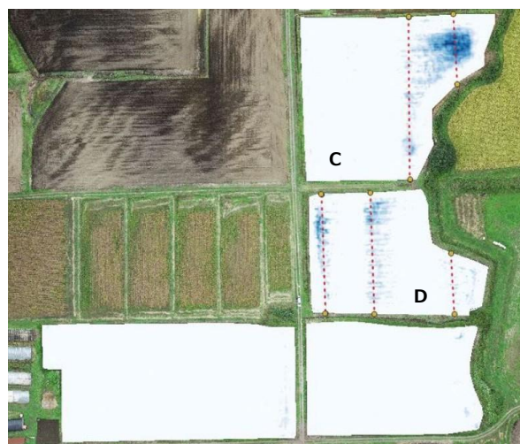
図10 凹凸マップと明渠施工プラン
