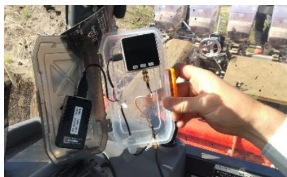
図9 キャビンの中に設置したRTK-GNSS受信機
