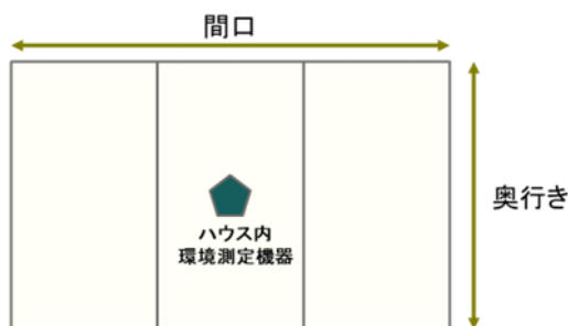
図 2:3連棟ハウスを上から見た場合のハウス内環境測定機器設置目安場所
