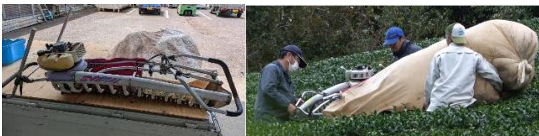
図3-7 可搬型摘採機(左)とそれを使った摘採作業(3人1組)(右)
