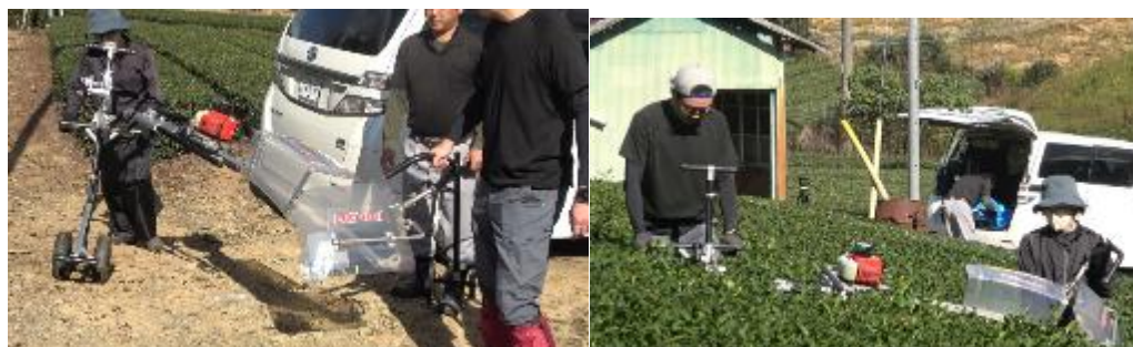
図3-14 後付け装置付き茶刈り機（左：外観、右：作業状態）
