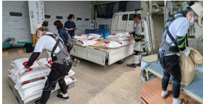
図3-16 アシストスーツ着用時の実験（左：肥料袋運搬、右：荒茶袋の締固め）
