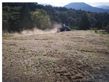
乗用トラクタ装着型フレールモア（マルチャー）による地表面処理（浅く耕起）
