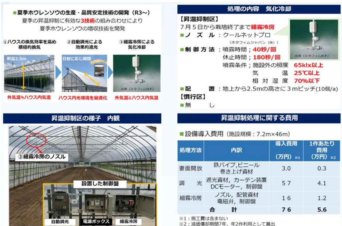
図表3-2-8:細霧冷房の概要（引用：広島県立総合技術研究所農業技術センター）
