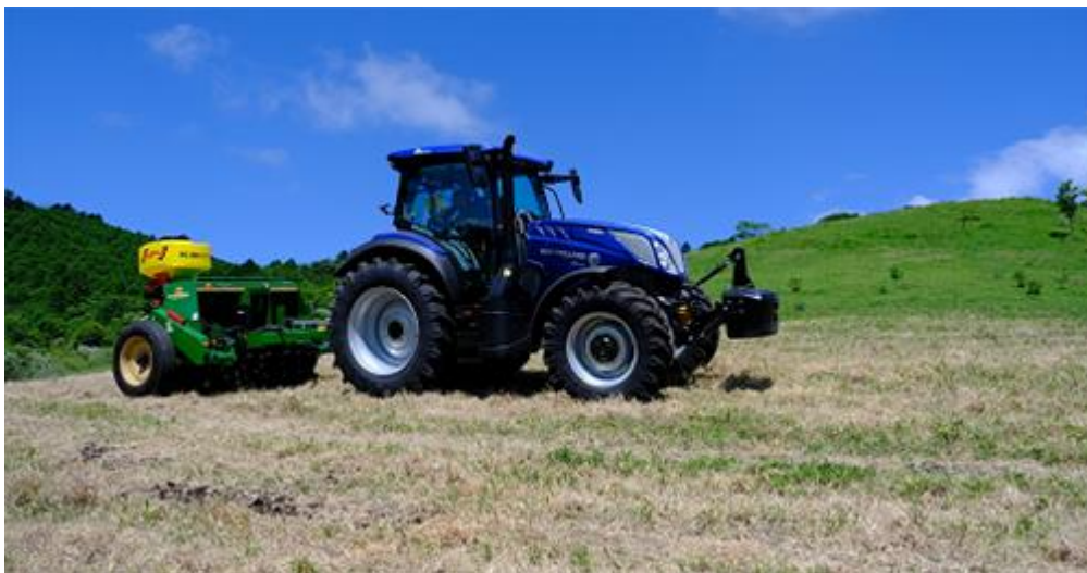
(写真5) 自動操舵トラクターによる播種作業の様子
