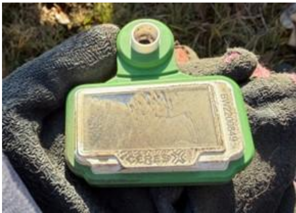
（写真8）太陽光パネルの汚れ
