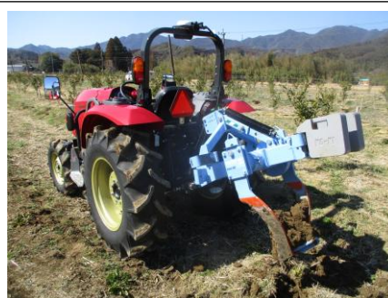
図11 全層心土破碎機による心土破碎の状況。
