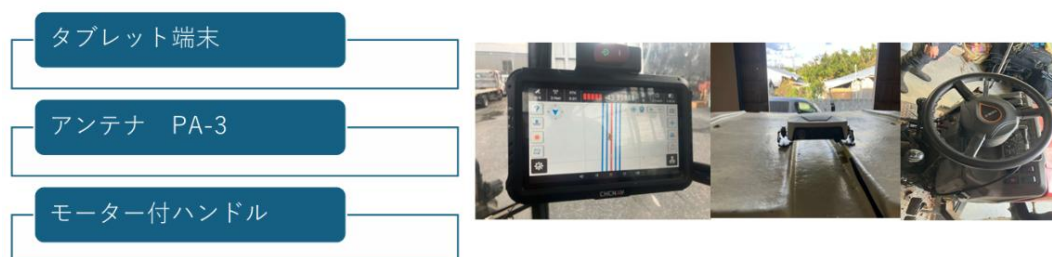
参考図2.7 GNSS自動操舵システムの主要機器の構成と取付状態
