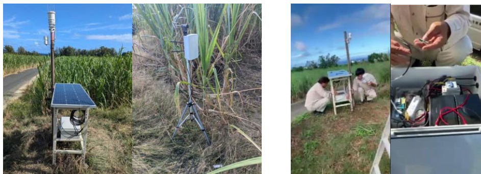
簡易型微気象観測ポスト及び圃場センサ(左) (右) 設置作業状況 図3.3.6 設置した微気象観測ポストと圃場センサ、及び、設置作業
