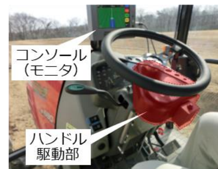
自動操舵システム（後付け型のトラクターへの装着事例） (東京計器株式会社製 AG-GEAR3)
