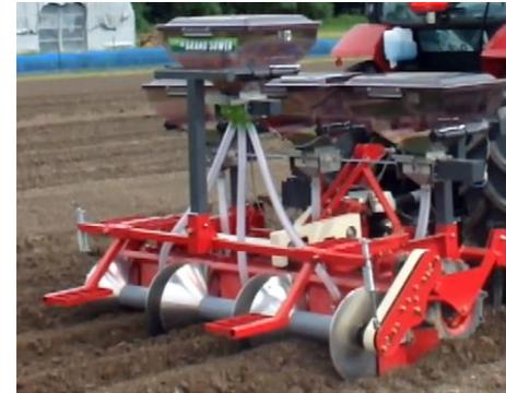
GNSS（衛星測位システム）と傾斜角度センサを用いることで、丘陵地帯でも繰り出し量が変動することなく設定した施肥量を播くことができる。コントローラーはデジタル化され、施肥量は液晶画面を見ながら数値で入力することができる。
