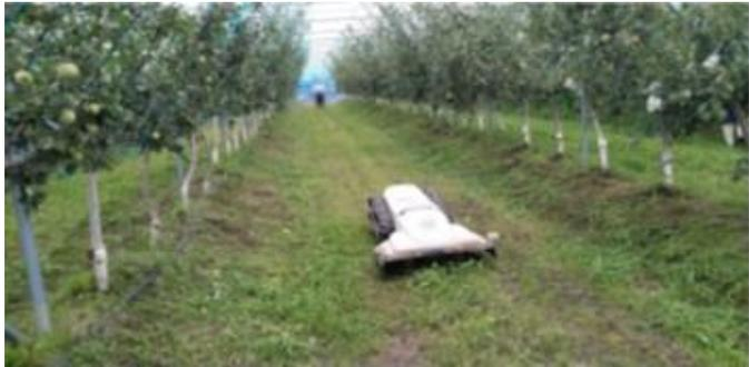
農作業支援ロボット台車・除草剤散布モジュール
