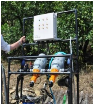
AI自動かん水・施肥システム (急傾斜地慣行栽培実証区)
