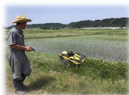
写真2 リモコン草刈り機1の作業状況 リモコン操作、走行駆動：モーター バッテリー、草刈：2サイクルエンジン 刈幅：63cm、重量：65kg
