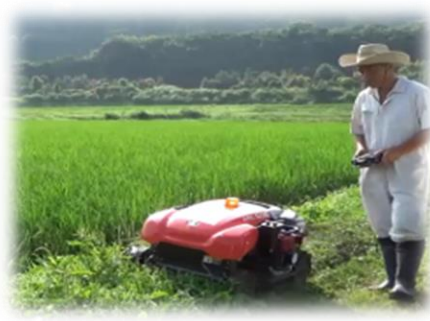
写真3 リモコン草刈り機2の作業状況 リモコン操作・動力：2サイクル エンジン、刈幅50cm、重量124kg
