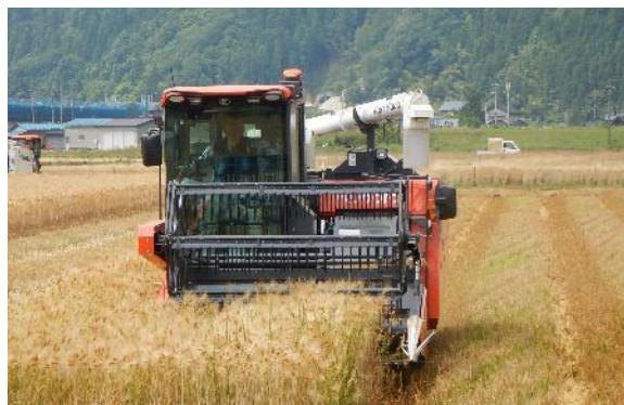
図1 収量・タンパク計測自動走行コンバインによる大麦の収穫作業
