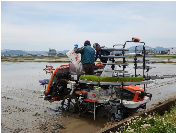
図1 直進アシスト田植機における2人組作業の様子
