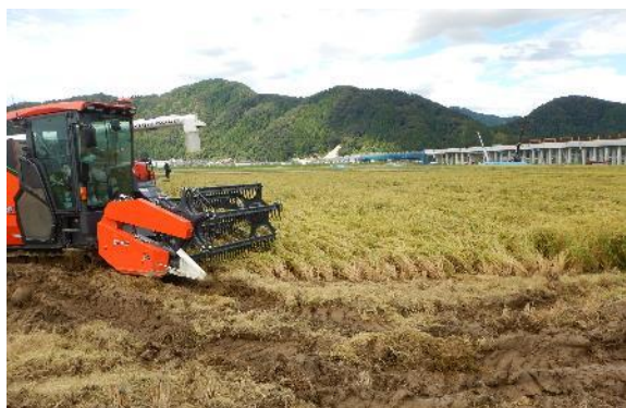
図2 収量・タンパク計測自動走行コンバインによるコシヒカリの収穫作業
