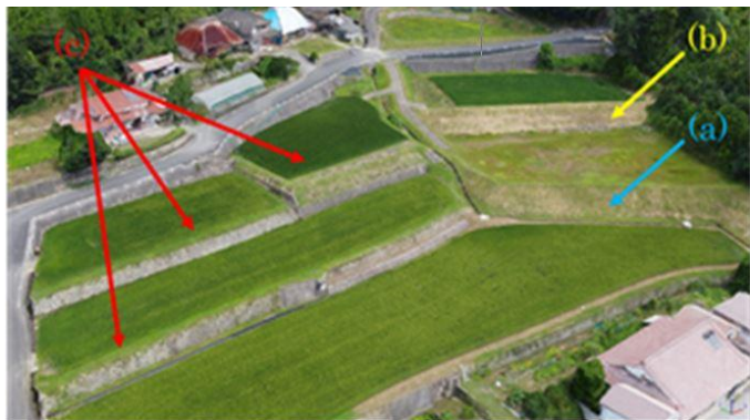
図2 畦畔形状の分類化 傾斜度 (a) 30度未満 (b) 30~40度 (c) 40度以上
