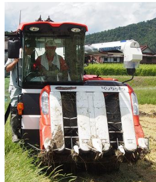
写真5 食味計付き収量コンバインでの、収量およびタンパク含有率の計測操作
