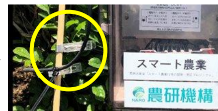
模擬枝にセンサー設置(改良型)
