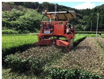
ロボット摘採機とロボット中切機の同時作業
