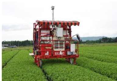
ロボット摘採機とロボット中切機の同時作業
