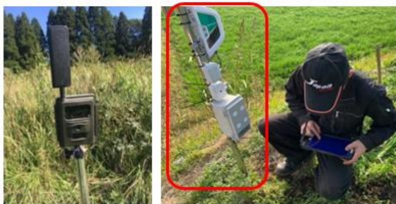
左:フィールドカメラ(FC) 右:フィールドサーバ(FS)
