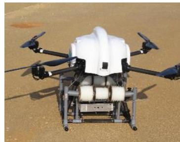
図3. チューブ繰出し方式による散布
