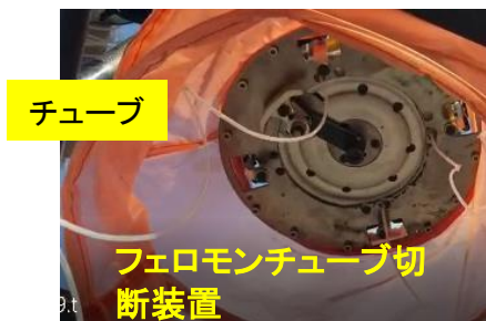
図4. 空中切断散布方式による散布(切断装置、現地試験)
