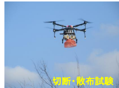
図4. 空中切断散布方式による散布(切断装置、現地試験)
