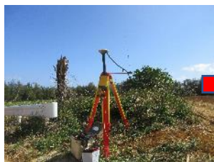
可搬式基地局を固定基地局として設置・利用
