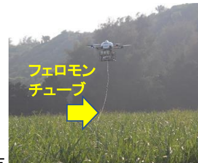
図3. チューブ繰出し方式による散布
