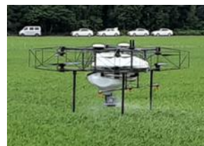
スポット散布実施UAV (マルチコプター、完全自動飛行)
