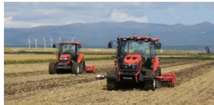
既存機がロボットトラクタを監視して2台で耕起
