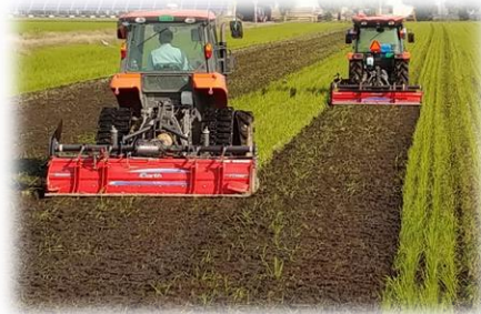
図1 無人トラクタの自動運転機能の実証 慣行トラクタ(手前、有人)と実証トラクタ(奥、無人)の協調作業
