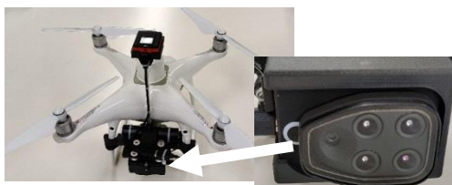
図3 空撮ドローン・マルチスペクトルカメラ
