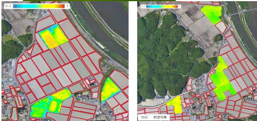
図12 センシングデータに基づく無人ヘリ可変施肥(水稻)(上) 小麦(下左)と水稻(下右)のNDVIマップ (FarmEyeより)
