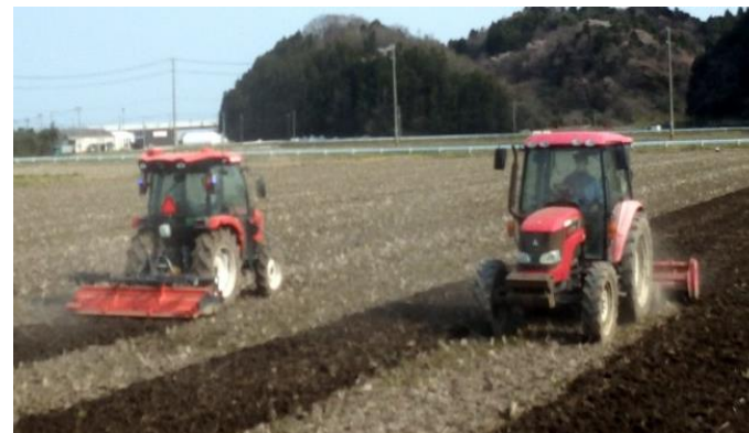
図4 有人トラクタとロボットトラクタ(無人)による耕起作業
