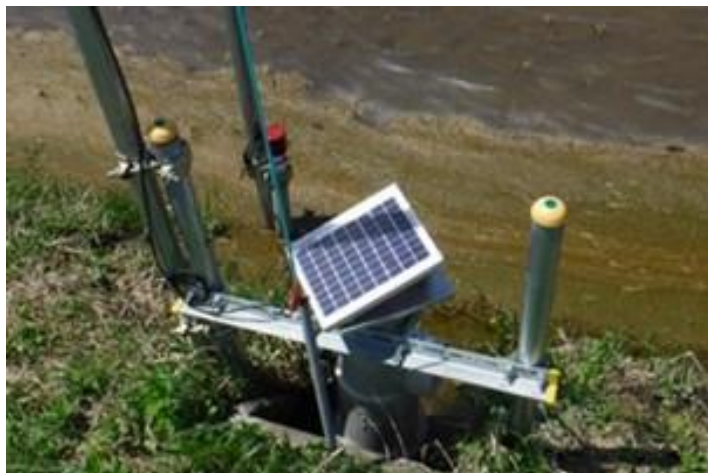
図6 水田給排水遠隔制御装置
