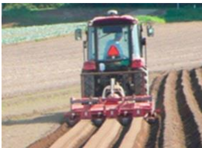
自動操舵トラクタによるキャベツうね立て整形作業
