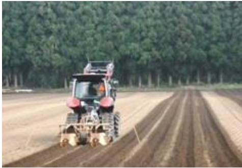
自動操舵トラクタによるナガイモのトレンチャー耕作業
