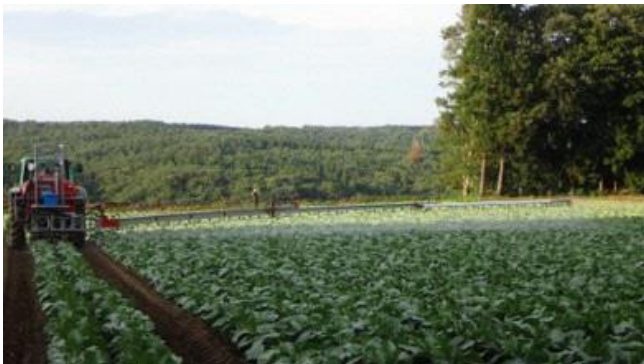
車速制御・静電ノズル付きブームスプレーヤによる薬剤散布作業
