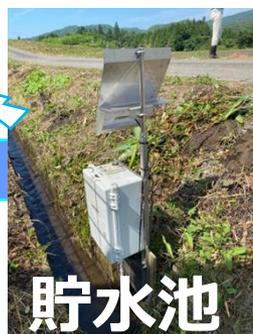
○ 貯水池の水位による開閉でき自動水門による省力化
