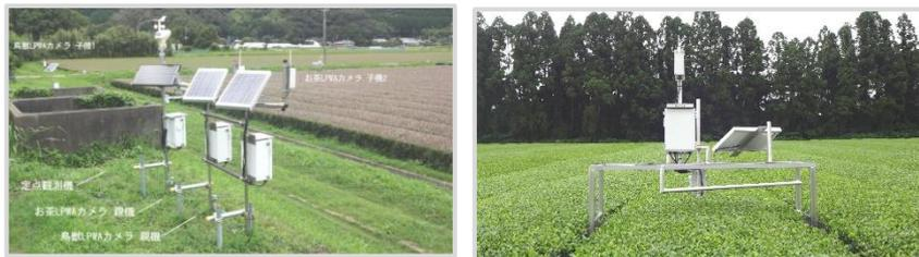
図1 開発した可動式LPWA静止画監視システム
