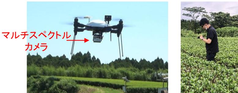
写真 ドローン・マルチスペクトルカメラによるリモートセンシングの様子(左)と簡易分光計での手持ち測定の様子(右)
