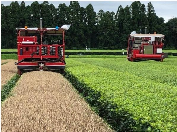
写真 摘採機(右)と中切機(左)の2台同時遠隔監視自動運転作業の様子
