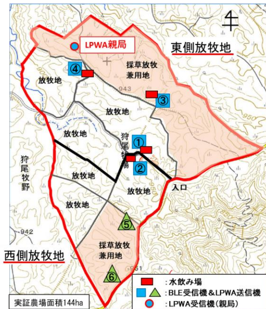
安否確認用機器の設置状況
