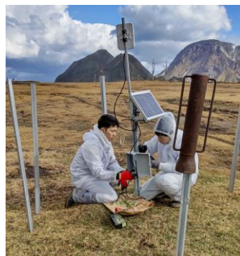
中継器(ソーラーで駆動)
