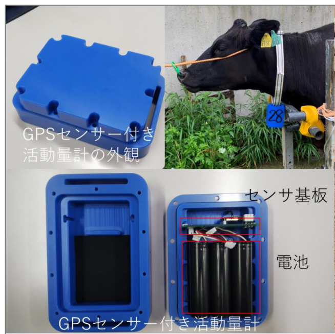
開発したGPSセンサー付き活動量計
